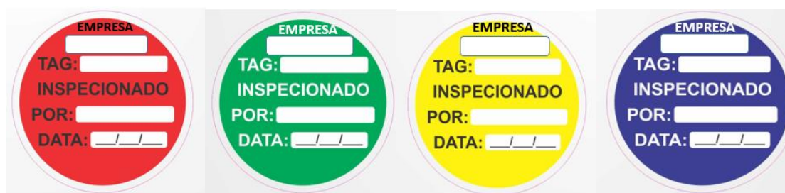
Figura 27 – Selo de inspeção em equipamentos elétricos.
